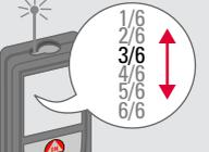
**i** Pour économiser de l'énergie, il n'est pas nécessaire de réduire la luminosité.
