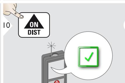
**i** Au bout de 2 secondes, l'appareil se remet dans le mode de base.
